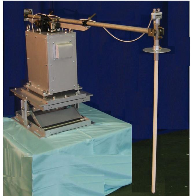
水平横棒式探針式ガラスレベルセンサー
